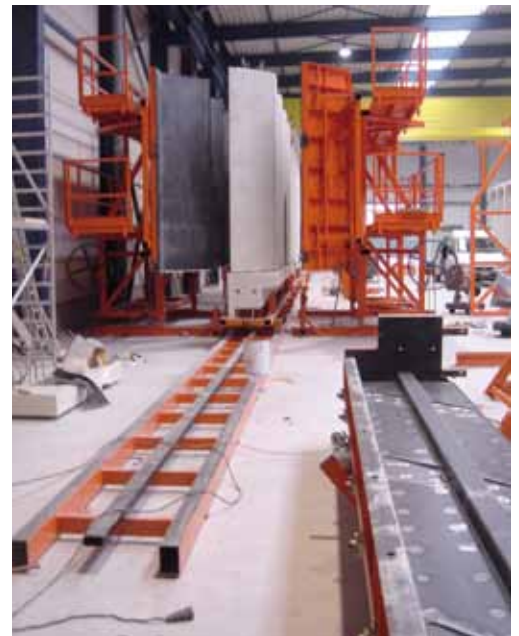
Production line for precast architectural and structural concrete wall elements. Productielijn voor de prefabricatie van architectonische, structurele betonnen gevelelementen. Ligne de production pour la préfabrication d'éléments de façade structurels et architectoniques.
