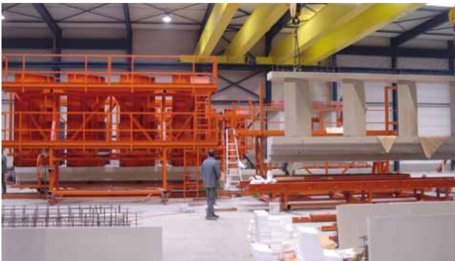
Production line for precast architectural and structural concrete wall elements. Productielijn voor de prefabricatie van architectonische, structurele betonnen gevelelementen. Ligne de production pour la préfabrication d'éléments de façade structurels et architectoniques.
