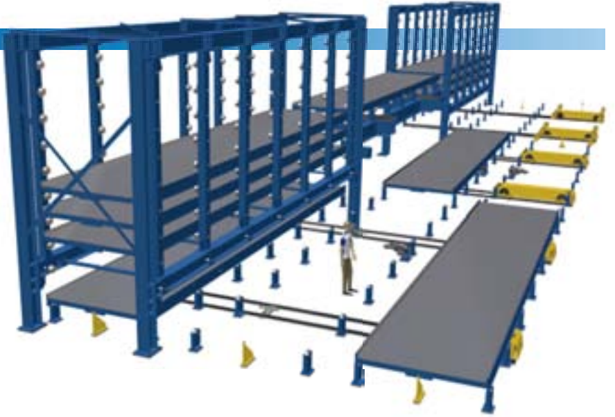
Carrousel system for filigree slab production. Carrouselstelsysteem voor breedplaatvloeren. Système carrousel pour la fabrication de prédalles.
